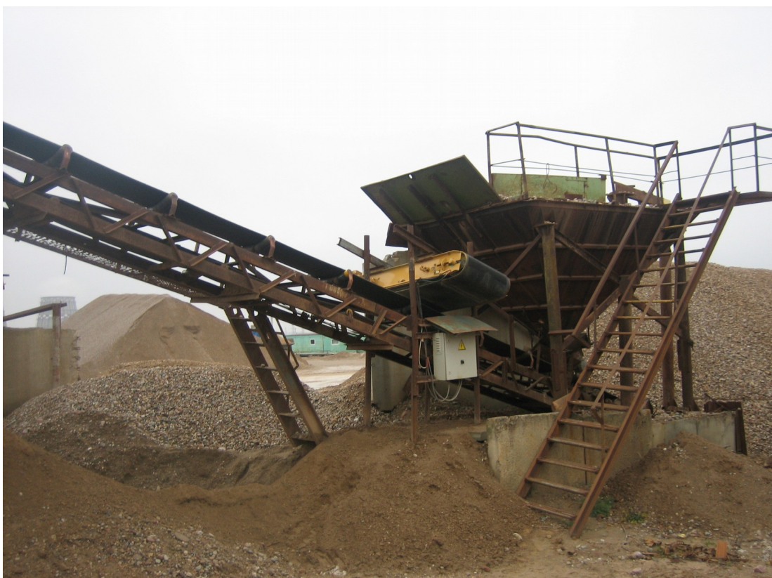
2.1.5 pav. Žvyro ir smėlio pakrovimas krautuvu į transporterio priėmimo – dozavimo bunkerį
