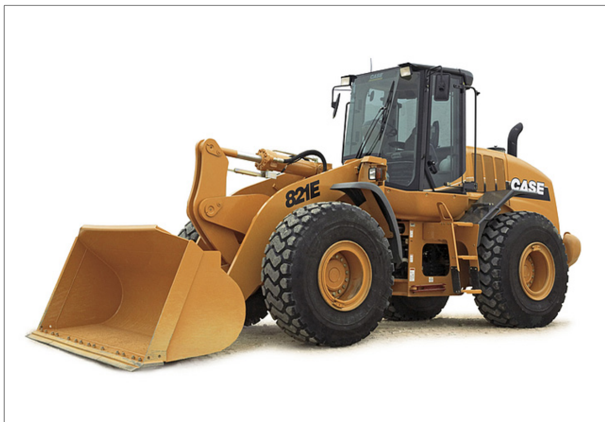
2.1.4 pav. Žvyro ir smėlio kasimas frontaliu krautuvu Case 821E
