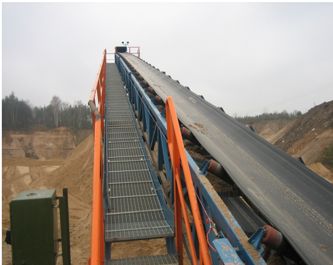
2.1.6 pav. Žaliavos patekimas iš priėmimo bunkerio ant technologinio transporterio
